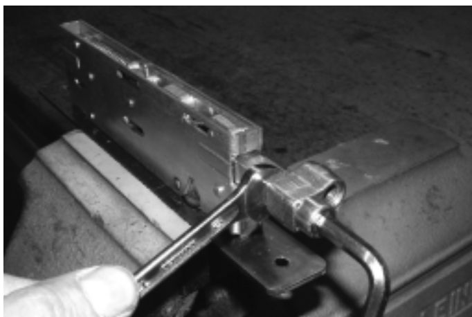
Abb. 25 Montage der Anschlussgarnitur 555.225 Fig. 25 Montage de la garniture de raccordement 555.225
