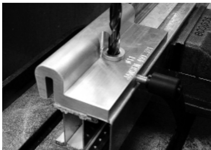
Abb. 3b Lehre positionieren und bohren (Riegel) Janisol primo
