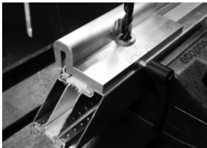
Abb. 4b Lehre positionieren und bohren (Blendrahmen) Janisol primo
