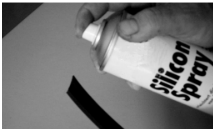
Abb. 33 Dichtungen mit Silikon besprühen Fig. 33 Vaporiser les joints avec du silicone
