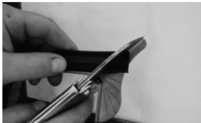
Abb. 18 Zuschnitt Aussendichtung Fig. 18 Coupe joint extérieur
