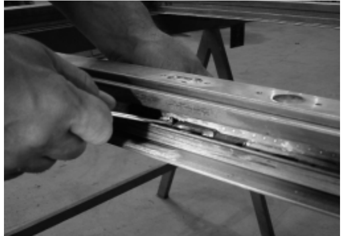
Abb. 27 Mit Gabelschlüssel verschrauben Fig. 27 Visser à l'aide d'une clé à fourche
