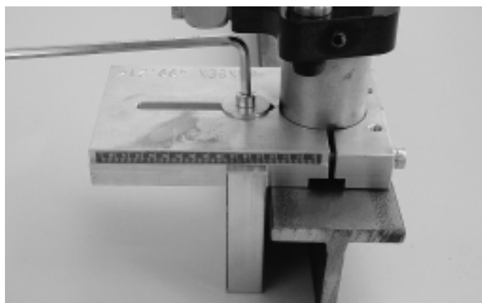
Abb. 4 Schweißlehre einstellen (Verstellbereich für Pfosten-/Riegelbreiten von 40 – 130 mm) Ill. 4 Ajuster le gabarit de soudage (zone ajustable pour largeurs 40 à 130 mm)
