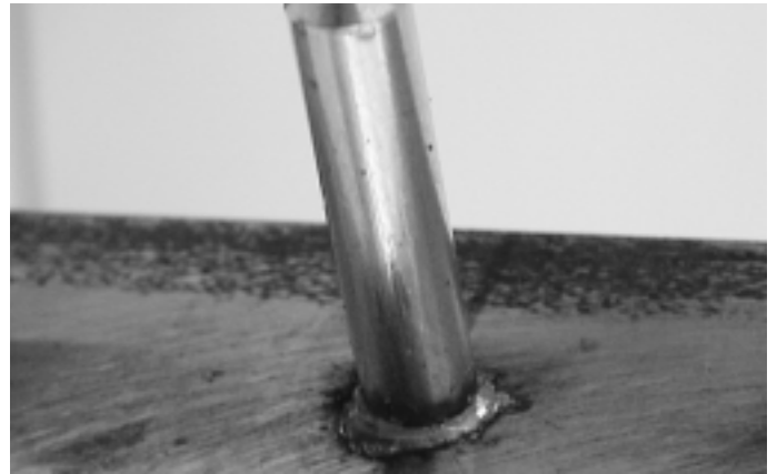
Abb. 10 Prüfung der Schweiss-Stelle durch Sichtkontrolle (umlaufend sauberer, gleichmässiger Schweisswulst) Ill. 10 Vérification de la soudure par contrôle visuel (entourage propre, cordon régulier)
