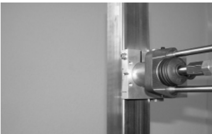
Abb. 13 Beim vertikalem Einsatz der Bolzenschweissung und bei starkem «Verblasen» des Schweißbades empfehlen wir als Hilfsmittel einen Keramikring einzusetzen Ill. 13 Nous vous recommandons d'utiliser une bague céramique comme auxiliaire en cas d'application verticale du soudage à l'arc avec percussion du soudage des goujons et de fort soufflage du bain de soudure
