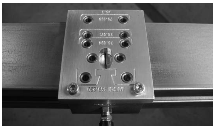
Positionierung der Bohrlehre an der Markierung Positionnement du gabarit de perçage au marquage Position the drilling jig on the mark
