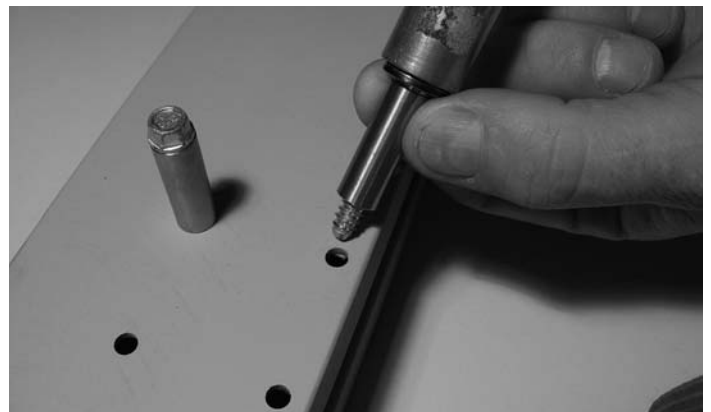
Setzen der T-Verbinder-Bolzen Pose du goujon de raccord en T Position the connecting spigot bolt
