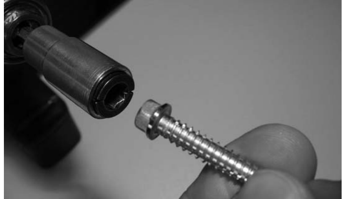
Einsetzen des Schraubenkopfes in den Adapter Pose la vis dans l'adaptateur Put the screw in the adapter
