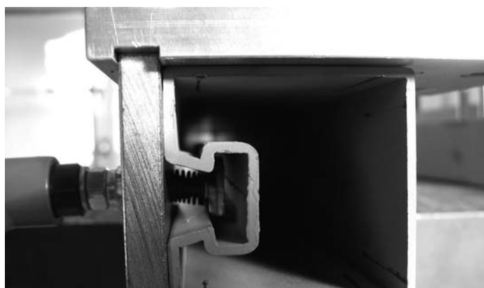
Fixierung der Klemmplatte in der VISS-Nute Fixation de la plaque de serrage dans la rainure VISS Fix the clamp in the VISS groove
