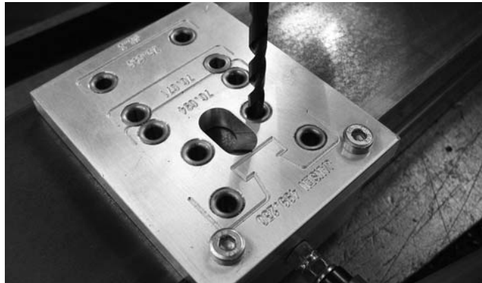
2 zusätzliche Bohrungen \varnothing 5,3 mm bei Pfosten 2 perçages supplémentaires \varnothing 5,3 mm sur le montant 2 additional drill holes \varnothing 5.3 mm for mullions
