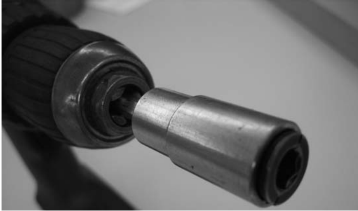
Schraubenadapter 499.395 zum Setzen der Schraube 6,3x38 Adaptateur à vis 499.395 pour pose de la vis 6,3x38 Screw adapter 499.395 for positioning the screws 6.3x38
