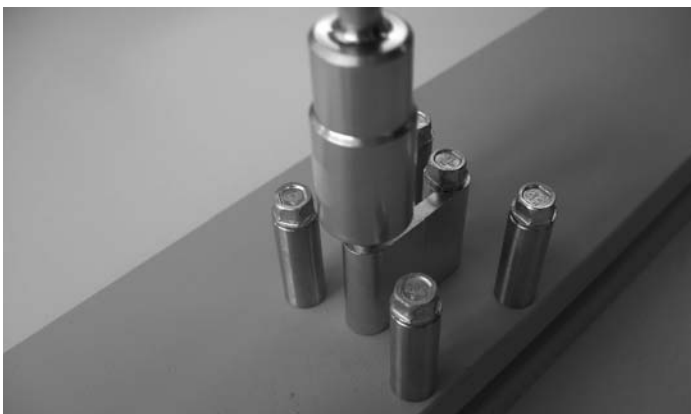
Verschrauben des Riegel-Befestigungsteils Vissage de l'élément de fixation traverse Screwing in the transom fixing component
