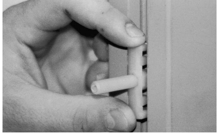
Abb. 2 Feder einklipsen Fig. 2 Clipser le ressort
