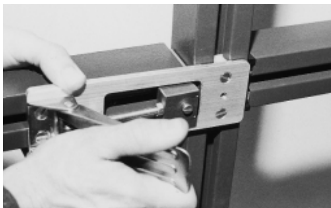
Abb. 34 Spannwerkzeug einsetzen und spannen Ill. 34 Appliquer l'outil spécial et tendre
